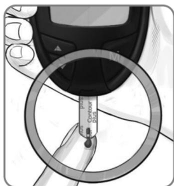
4. Mettre immédiatement l'**extrémité** de la bandelette réactive au contact de la goutte de sang. Le sang est aspiré dans la bandelette réactive par capillarité au niveau de son extrémité.
