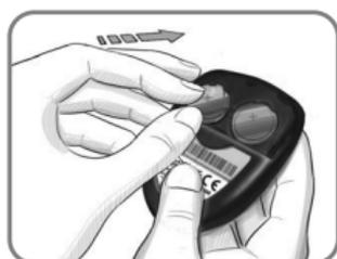
4. Placer les piles neuves sous les ergots et dans le compartiment à pile avec le « + » vers le haut. [Utilisation de deux piles au lithium de 3 volts (DL2032 ou CR2032).]
